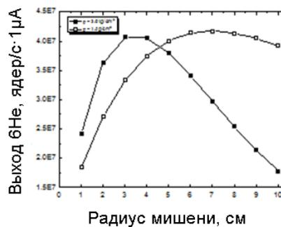
рис.3. Зависимость выхода  ${}^6\text{He}$  от радиуса мишени  $\text{BeO}$
